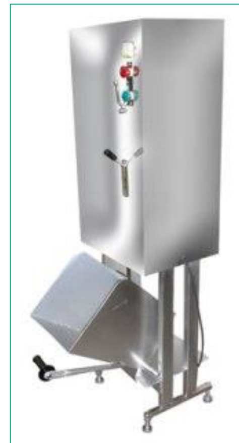
Пресс-деструктор, применяется для изменения внешнего вида отходов
